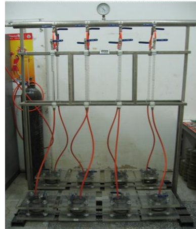
รูปที่ 4 การทดสอบค่าการซึมของน้ำผ่านคอนกรีต โดยอาศัยหลักการไหลของน้ำที่ลงที่
