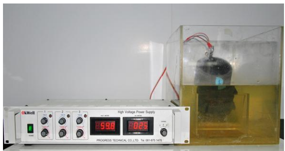
รูปที่ 3 การทดสอบหาค่าการแทรกซึมของคลอไรด์ผ่านคอนกรีต ตามมาตรฐานของ NT BUILD 492 [9]
