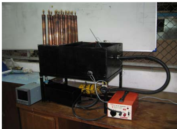
รูปที่ 4 เครื่องระบายความร้อนน้ำมันไฮดรอลิกส์ [6]
