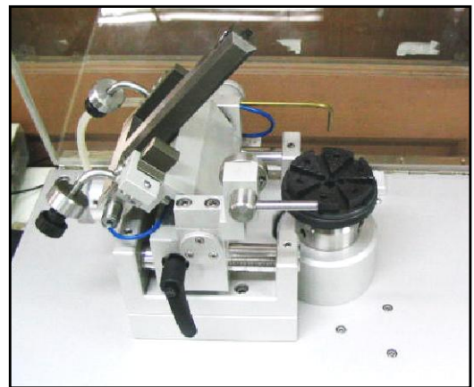
รูปที่ 1 การทดสอบด้วยวิธี Ball-on-disk บนเครื่องไดรฟ์มอเตอร์
