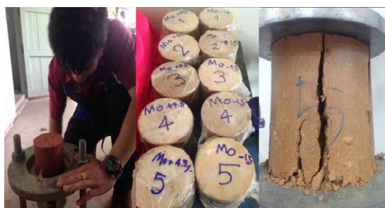
รูปที่ 3 ก่อนตัวอย่างที่ใช้ในการทดสอบกำลังรับน้ำหนัก
