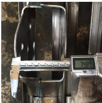
รูปที่ 2 ตำแหน่งของชิ้นงานที่ถูกวัดขนาดการโค้งตัว
