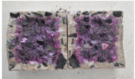
รูปที่ 2 ตัวอย่างผลของก๊อนตัวอย่างคอนกรีตที่ผ่าซีกหลังจากแช่ในดูลบแล้วทำการทดสอบการเกิดคาร์บอนเนชั่น บริเวณเนื้อคอนกรีตที่ไม่เป็นสีม่วงเป็นบริเวณเกิดคาร์บอนเนชั่น
