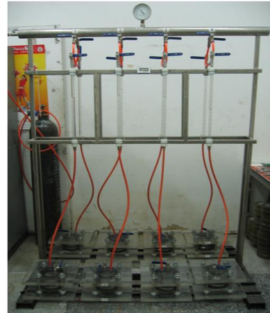
รูปที่ 4 การทดสอบหาค่าการซึมของน้ำผ่านคอนกรีต โดยอาศัยหลักการไหลของน้ำที่คงที่
