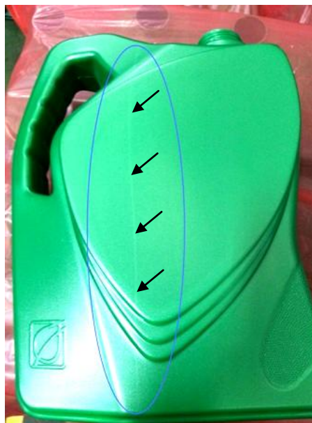
รูปที่ 2 ลักษณะข้อบกพร่องประเภทเส้นสี (Color-mark)
