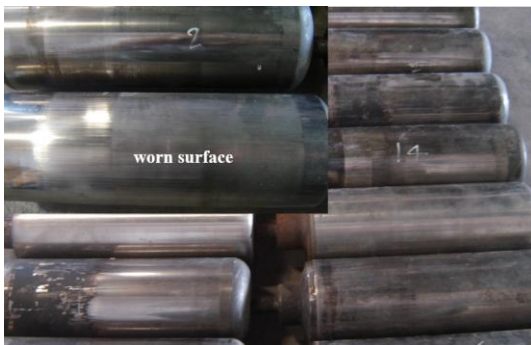
รูปที่ 1 ตัวอย่างชิ้นงาน Plunger ที่สึกหรอบริเวณผิวหลังจากการใช้งาน
