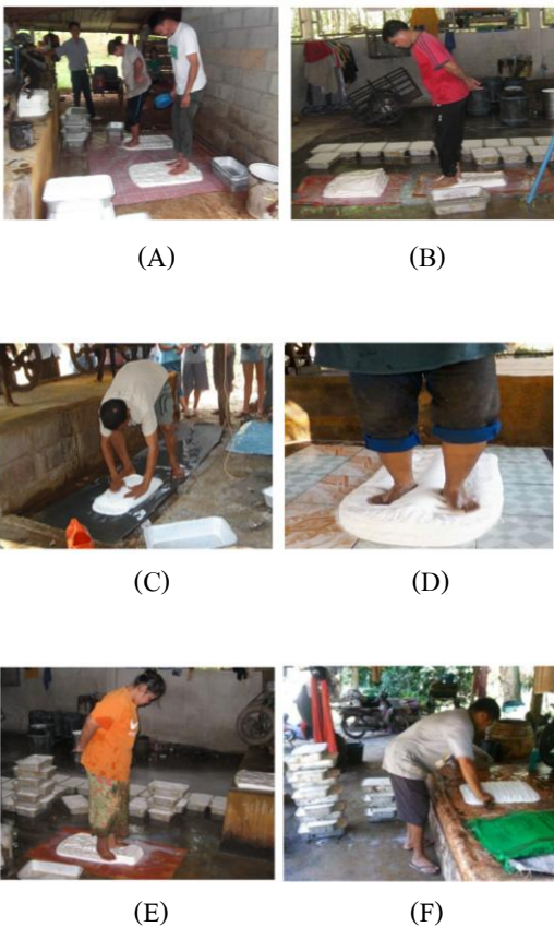
รูปที่ 3 ลักษณะการนวดยางเป็นแผ่นบางๆ
