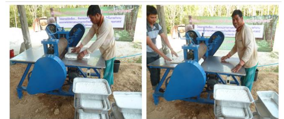
รูปที่ 5 แนวทางออกแบบสร้างเครื่องนวดข้างแผ่น โดยการลดท่าทางการเคลื่อนไหวจากการทำงาน
