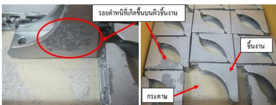
รูปที่ 2 ลักษณะตำหนิบนพื้นผิวชิ้นงาน
