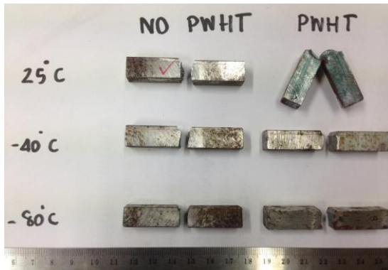
รูปที่ 9 ชิ้นงานเชื่อมเหล็กกล้า 3.5% โครเมียม หลังการทดสอบแรงกระแทกที่อุณหภูมิทดสอบต่างๆ
