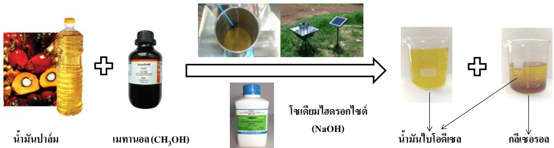
รูปที่ 2 แสดงขั้นตอนการสังเคราะห์น้ำมันไบโอดีเซลโดยใช้เครื่องปฏิกรณ์ต้นแบบพลังงานแสงอาทิตย์
