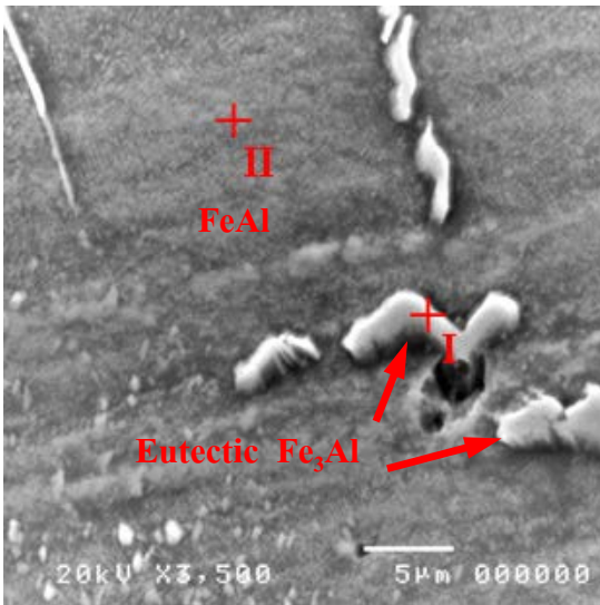
รูปที่ 6 โครงสร้างจุลภาคแนวเชื่อมพอกผิวแข็ง และสเปกตรัมของการวิเคราะห์ด้วย EDS ความเร็วในการเติมลวด อลูมิเนียม 10 เมตร/นาท
