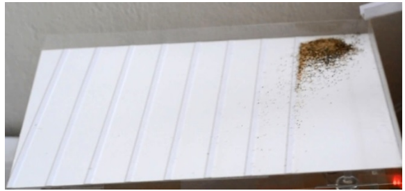
รูปที่ 4 การทดลองแต่งแร่ด้วยโต๊ะสั้น ที่วินาทีที่ 1
