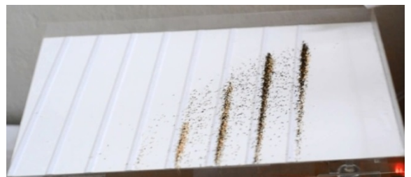
รูปที่ 8 การทดลองแต่งแร่ด้วยโต๊ะสั่น ที่วินาทีที่ 16
