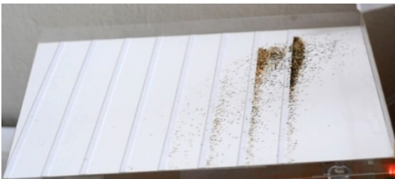
รูปที่ 6 การทดลองแต่งแร่ด้วยโต๊ะสั่น ที่วินาทีที่ 8
